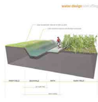
Figura 8.54 Orillas de los canales que pueden convertirse en terrazas arboladas. En algunos casos, hay suficiente espacio para insertar una vía peatonal, instalaciones y espacios públicos. Figura 8.55 Sección tipo del canal.
