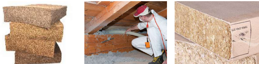
Slika 2: Ekološki izolacioni materijali (drvena vuna, vlakna od konoplje i jute, paneli od slame)
