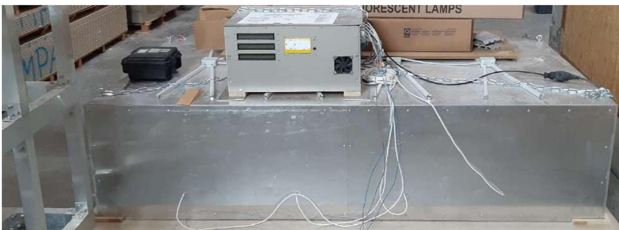
Abb. 11: UV-A- Bestrahlungseinrichtung für Unterdachelemente
