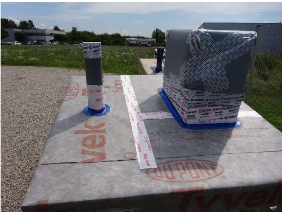
Abb. 9: Kombiniertes T-Stoß/Durchdringungselement eines Herstellers. Die Abdeckung des Kamins und des Rohrs dienen lediglich der Abdichtung der Durchdringungsquerschnittes gegen eindringendes Regenwasser und sind nicht Gegenstand der Untersuchung.
