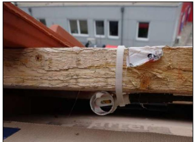
Abb. 60: Temperatur/Luftfeuchte Kombifühler mit Strahlungsschutzring aus Aluminium
