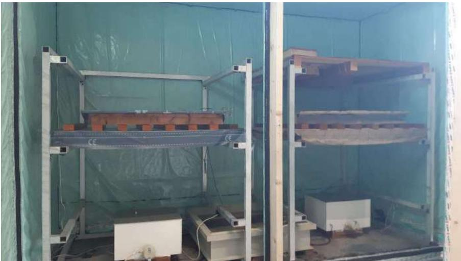
Abb. 12: Innenansicht des von der HFA gebauten Klimakammer für maximal sechs Unterdach-Elemente zur klimatischen Alterung bei 70 °C und 90% rF. Im unteren Bereich sind Heiz- und Befeuchtungseinrichtungen zu sehen.
