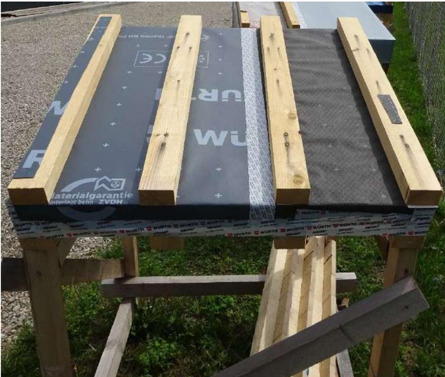
Abb. 8: Konterlattenelement mit Unterdachsystem von zwei Herstellern (jeweils zwei Konterlatten mit Nagelbild gemäß [5]). Auf den jeweils äußeren Konterlatten ist ein Referenzstreifen der Unterdachbahn aufgebracht, um laufend Proben für die spektroskopische Untersuchung entnehmen zu können.
