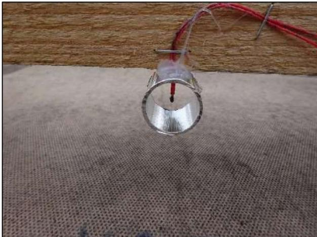
Abb. 59: NTC-Temperaturfühler mit Strahlungsschutzring aus Aluminium
