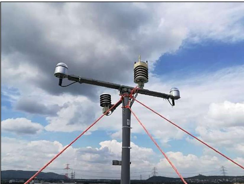
Abb. 56: Wetterstation am Dach des Akustik Center Austria der HFA in Stetten
