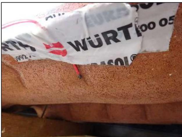
Abb. 61: NTC-Temperaturfühler an Ziegelunterseite
