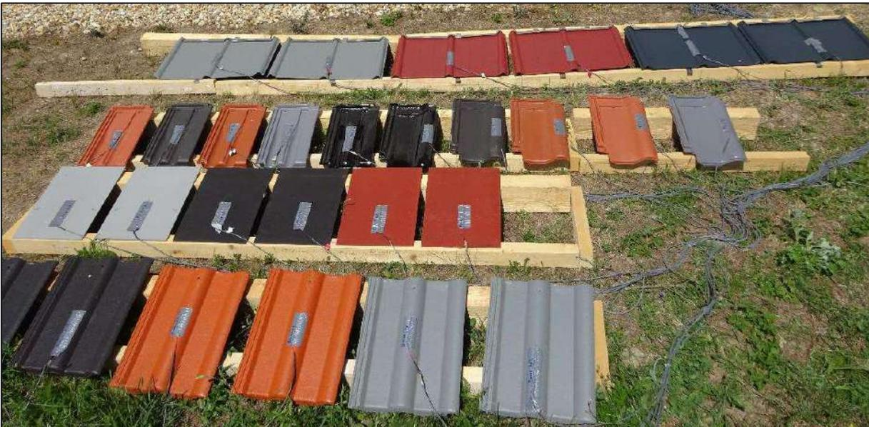
Abbildung B1: Oberflächentemperaturmessungen im Freiland an verschiedenfarbigen Dacheindeckungen aus unterschiedlichen Materialien
