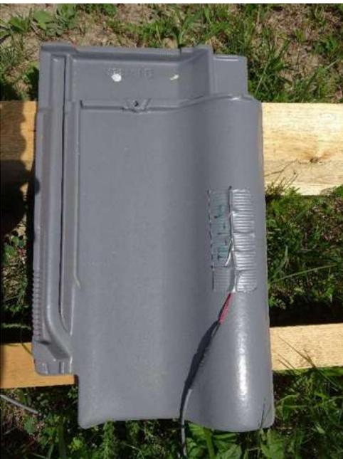
Abbildung B3: Oberflächentemperaturmessung mit angeklebtem NTC-Fühler
