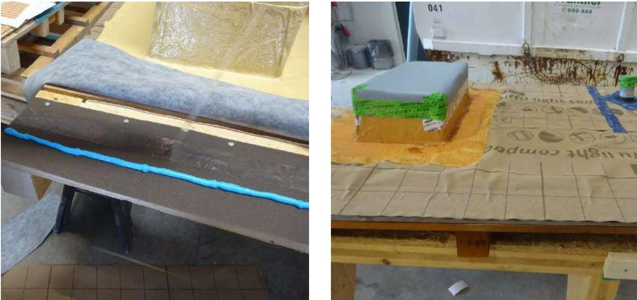
Abb. 27: Beispiel eines Unterdachsystems mit Flüssigabdichtung der Kamineinbindung und Traublecheindichtung bei der Herstellung (links) und nach der künstlichen Alterung (rechts)
