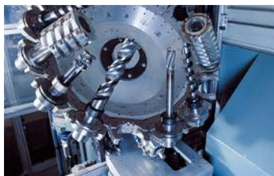
Abb. 8.05 Werkzeugmagazin einer CNC-Abbundmaschine
